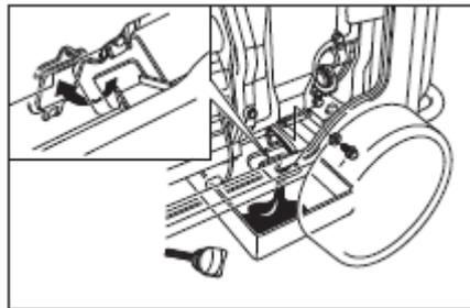
**NOTA:** NÃO inclinar o gerador ao adicionar óleo do motor. Isto pode causar um transbordamento do óleo e danos ao motor.
