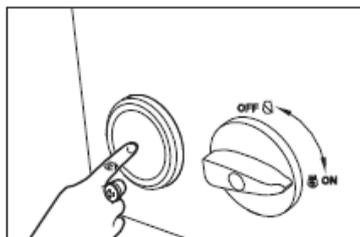
3. Prima e solte o botão interruptor start. O interruptor de arranque ligará o motor durante 5 segundos. Quando o motor arranca com sucesso, o motor de arranque pára automaticamente. Se o motor não arrancar com sucesso, aguardar pelo menos 10 segundos antes de arrancar novamente.
