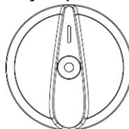
3. Rodar o interruptor de alimentação/funcionamento/arranque a frio para a posição “Arranque a frio”.
