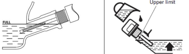
(Figura 1: imagem à esquerda para P3000i-P3500i-P3500lo, imagem à direita para P7500i)
