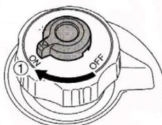
2. Segurando firmemente a tampa do tanque de combustível para que não se mova, rodar o botão da ventilação para a posição “ON” (quando disponível).
